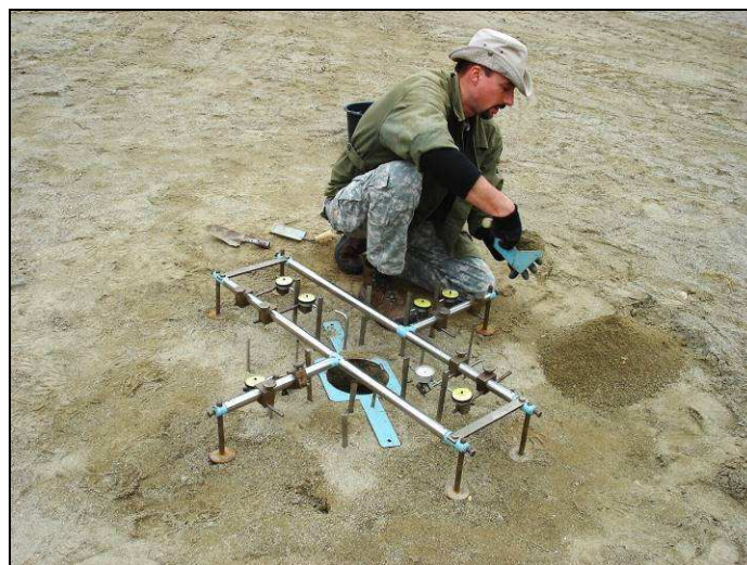
Obr. 6 Měření napjatosti v pískovně v Brně-Černovicích Mencl-Fussgängerovou metodou
