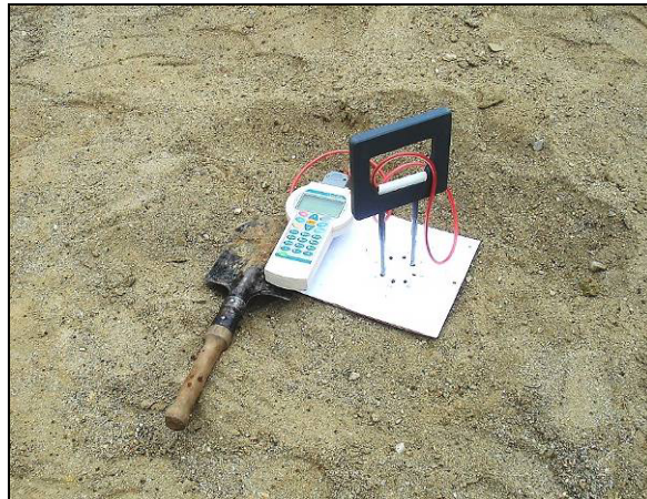
Obr. 4 Dvojice elektrod EIS ve tvaru vidličky napojených na Z-meter III v masce pro měření impedance in situ
