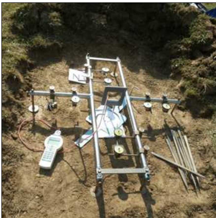
Obr. 13 Měření napjatosti na lokalitě Luhačovice Mencl-Fussgängerovou metodou
