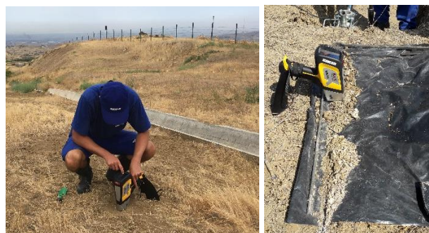
Obr. 3: Průzkum povrchové kontaminace a měření čistých pesticidů z tělesa skládky pomocí ED-XRF spektrometru DELTA
